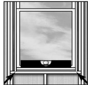
**ATENCIÓN** Coloque calzos debajo de las esquinas inferiores y en cada punto de arrastre en las unidades de varios anchos. La colocación de calzos en cualquier otro lugar debajo del travesaño inferior puede hacer que éste se arquee.
