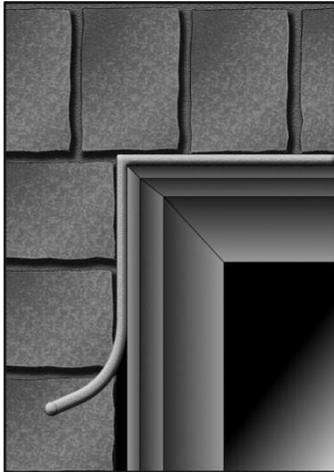
**b) Aplique el cordón de refuerzo.** (Sólo para aplicaciones de mampostería) Aplique el cordón de respaldo de espuma de célula cerrada en el espacio entre el perímetro exterior de la ventana y el material de acabado de la pared.
